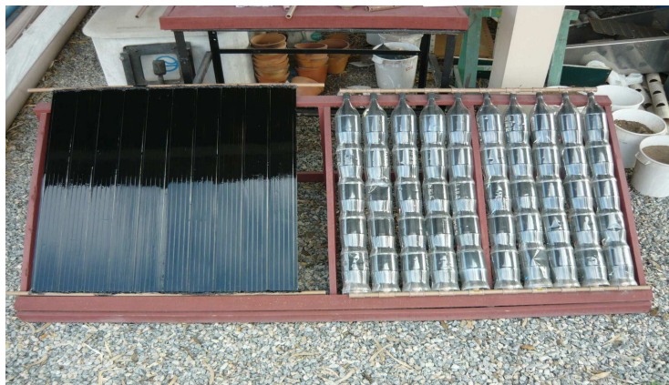
Figura 2 – Painéis solares de baixo custo. A esquerda painel de PVC e a direita painel constituído por garrafas PET (Pelotas, 2009)
