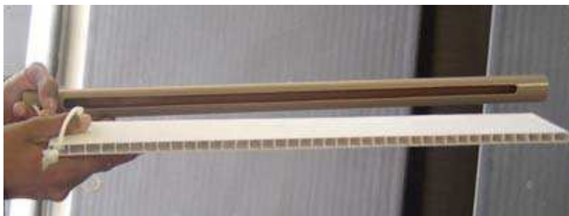
Figura 1 – Detalhe da montagem do painel de PVC (SOSOL, 2008).
