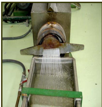
Figura 11: Tanque de resfriamento
